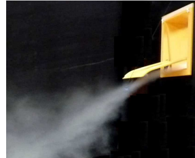
Luftleitung in den Tierbereich
